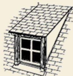
Lucarne rampante ou en chien couché
